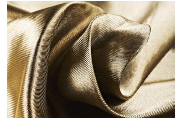
石金玄武岩生產的玄武岩織物，在抵禦 6.5Km/s 空間碎片撞擊上，可使抵禦能力提高 3 倍以上，被應用於中國航空空間站建設
